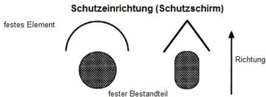
Ein Schutzschirm ist ein festes Element, das als Windschutz oder Windabweiser dazu dient, einen anderen festen Bestandteil des Fahrrades zu schützen, damit die aerodynamischen Widerstände reduziert werden.
